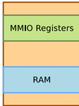
Espacio de direcciones en memoria física, accesible mediante instrucciones de carga/almacenamiento normales
